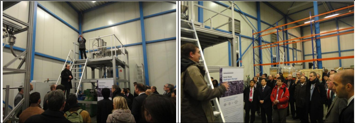
Prof. Dr. Thomas Klassen (linkes Bild) und Dr. José Bellosta von Colbe (rechtes Bild) erklären die hermetisch geschlossene Prozessanlage (Basis Zoz-Simoloyer® CM100) zur Herstellung komplexer Leichtmetallhydride für H2-Tank-Prototypen
