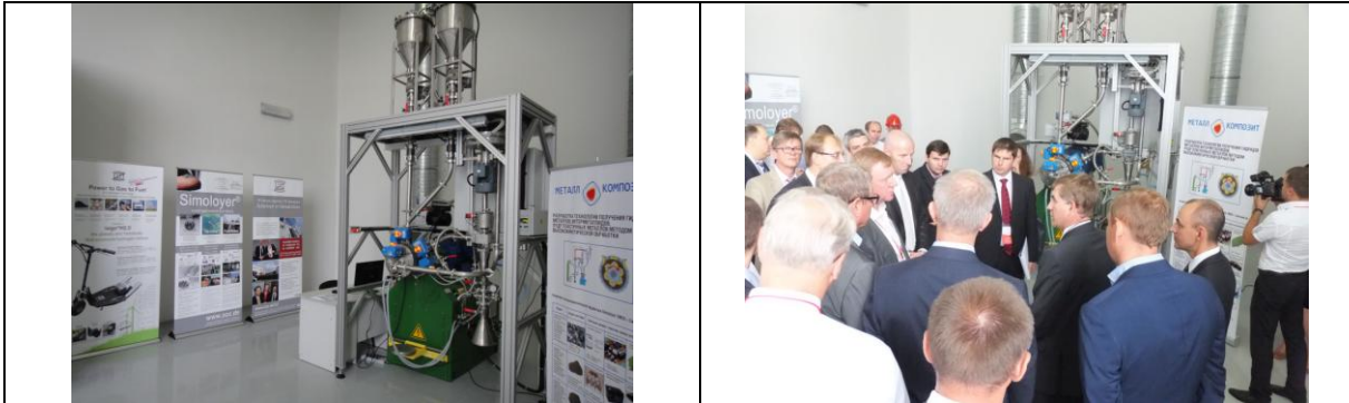
Simoloyer® CM20 Anlage in Ulyanovsk für Forschung und Produktion von nanostrukturierten Werkstoffen
