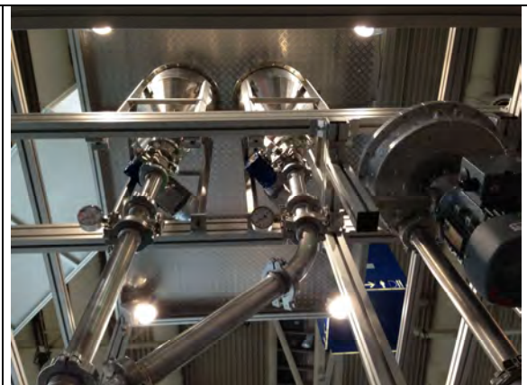
Vakuum-Materialzuführung (oben) und Trägergas-Turbine (rechts)
