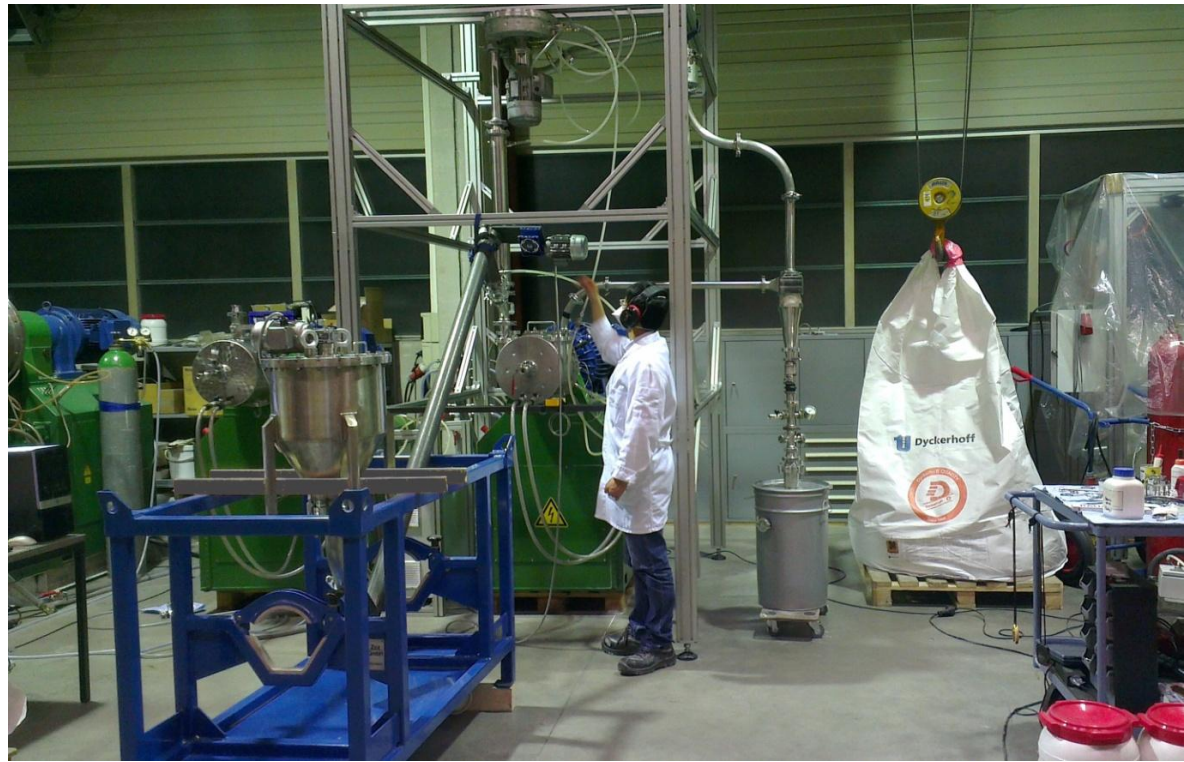
Hochkinetischen Prozessanlage (HKP) auf Basis Simoloyer® CM20-20lm-s1 (Zoz baut solche Anlagen bis zu 45x größer) mit kontinuierlichem Materialfördersystem. Hiermit werden zurzeit in Doppelschichten die nanostrukturierten Werkstoffe für Brücke und Obeliske hergestellt.
