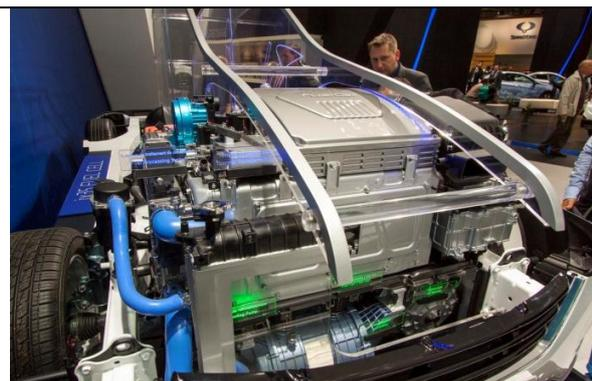
Antriebsaufbau des Hyundai ix 35 Fuel Cell
