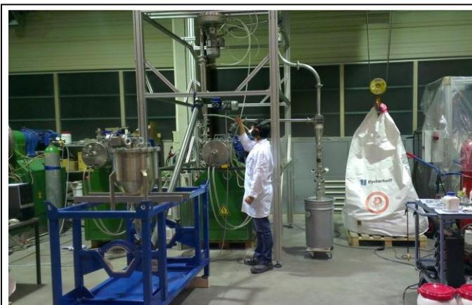
Herstellung von nanostrukturiertem Hüttensand im Tonnenmaßstab mittels Hochkinetischer Prozessanlage Simoloyer® CM20-20lm-s1 (Zoz baut solche Anlagen bis zu 45x größer) mit kontinuierlichem Materialfördersystem für Zement
