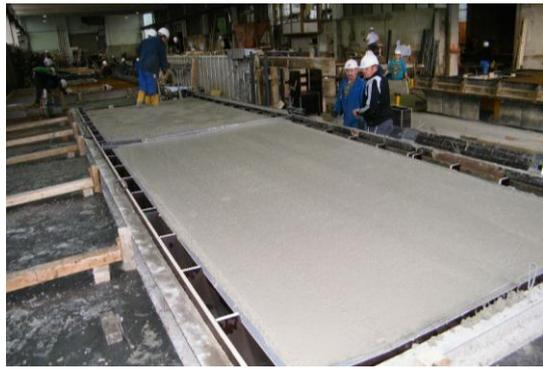
Herstellung der Brückenplatte bei der Fa. Runkel am 05.11.2012
