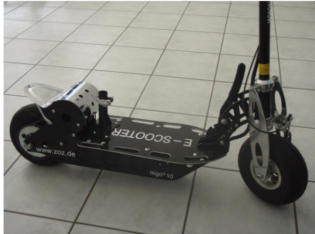
Prototyp A1 ist bestimmt für die Kick-Board Baugröße Isigo®, Geschwindigkeit 35 km/h, Reichweite dann ca. 70 km
